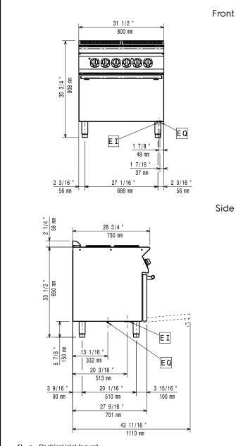
El = Electrical inlet (power) EQ = Equipotential screw
